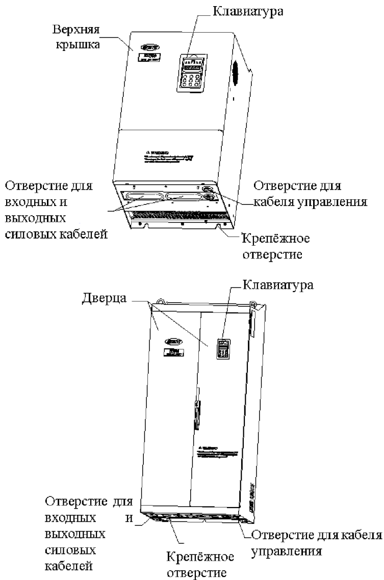
Рис.2-4 Внешний вид и наименование деталей EN500
