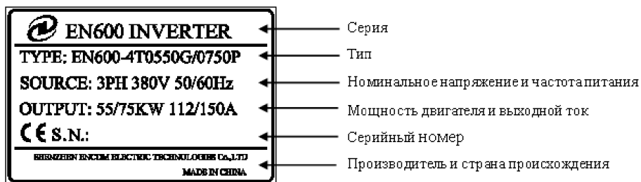
Рис.2-2 Расшифровка обозначений паспортной таблички преобразователя частоты.
